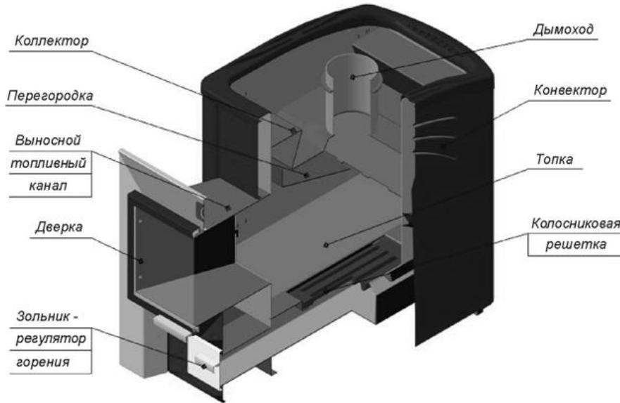
Рисунок 1 – Конструкция печи
