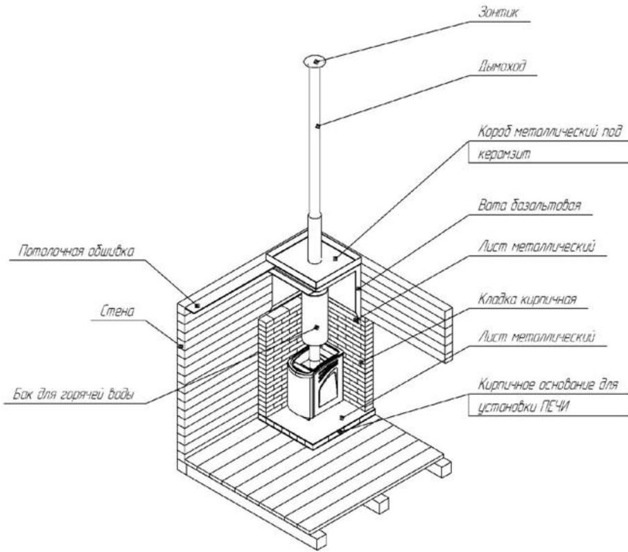
Рисунок 2 – Схема монтажа печи
